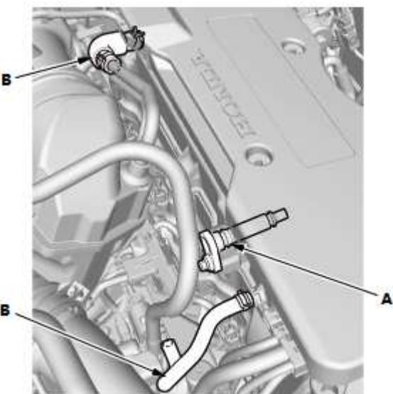
1. 检查 PCV 阀 (A)、软管 (B) 和它们的连接处是否泄漏或堵塞。
